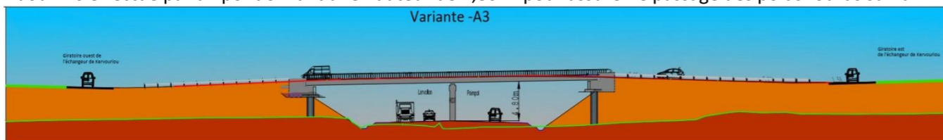
Figure 1 : La coupe de la variante 3 (A3) au droit de l'échangeur de type « losange » en passage supérieur (PS) à la RD7 à « Kervouriou-Naour »
