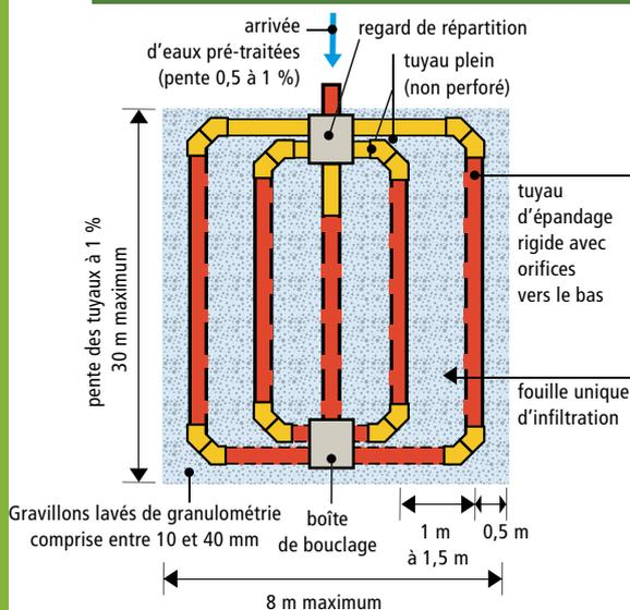
Le niveau haut de la nappe doit se situer à au moins 1 mètre du fond de fouille. Cette hauteur peut être augmentée en fonction de la nature du sol.
