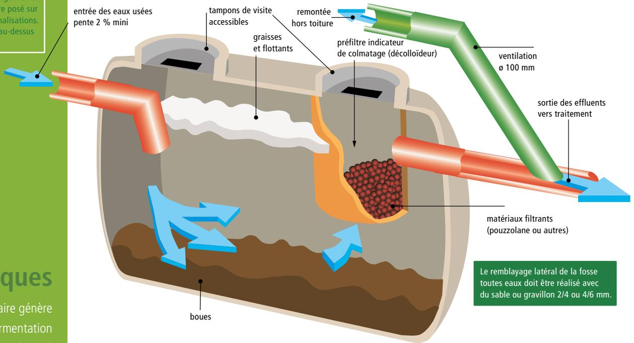
Le remblayage latéral de la fosse toutes eaux doit être réalisé avec du sable ou gravillon 2/4 ou 4/6 mm.
