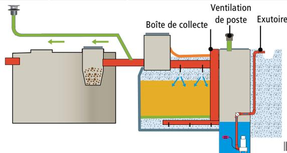
**Attention :** dans ce type de configuration, l'étanchéité du filtre et du regard de relevage doivent être très soignées. La hauteur de déclenchement de la pompe doit être impérativement inférieure au fil d'eau de sortie du filtre.
