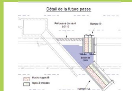
Le système est complété par un réagencement des blocs à l'aval du pré-barrage et par la démolition de l'ancienne passe à bassins. Les travaux d'un coût total de 61 116 € TTC, auront lieu en période de basses eaux du Trieux d'ici fin 2021.
