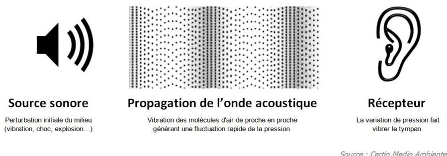
**Figure 1 : schéma de propagation du son dans l'air.
