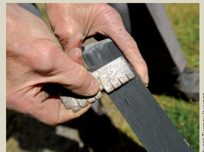
Le gabarit sert à mesurer l'épaisseur des ardoises.
