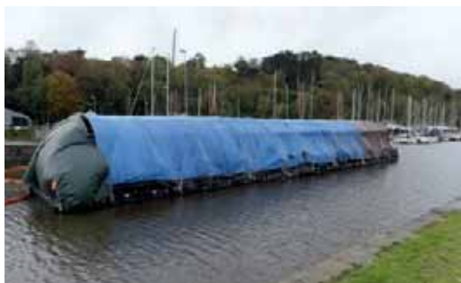
Le pont, entièrement bâché pour les opérations de sablage.
